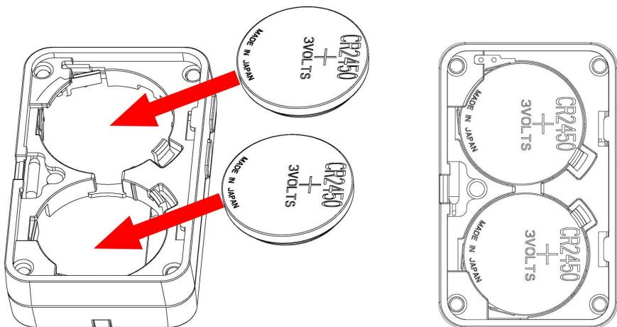
注：安装电池請使用一字螺絲起子之類的工具輔助打開電池蓋.
